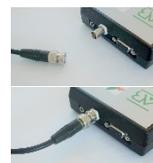
☞ Die Kontakthülsen auf die Messspitzen schrauben.
